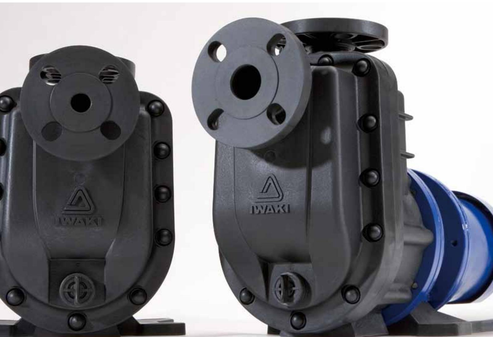
SMX-F シリーズは、耐薬品性に優れたフッ素樹脂を採用したよこ型自吸式マグネットポンプです。弊社独自のセルフラジエーション構造（PAT.）の採用で、空運転・キャビテーション・締切り運転などの異常運転に強くなりました。また、市販モータの取付けで使用範囲が大きく広がりました。
